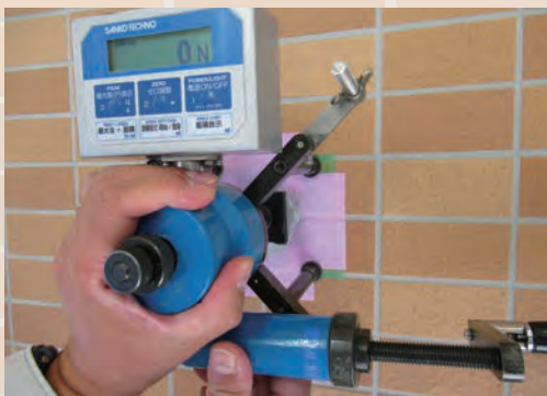
④ 引張試験器テクノスターRJ-1にて目地モルタル強度確認試験を行う
