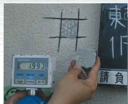
確認基準強度0.4N/mm 2 以上であることを確認する
