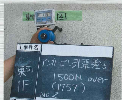
確認基準強度1.500N以上であることを確認する
