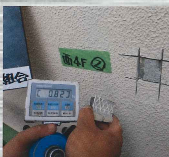
GNSフィラー付着力試験
